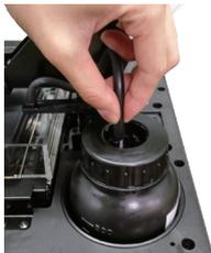
**Примечание** Перед заменой бутылки с полимером сначала отсоедините прозрачную трубку от крышки, а затем черную трубку.
