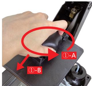
①-A Поверните запирающее устройство платформы против часовой стрелки до упора.
