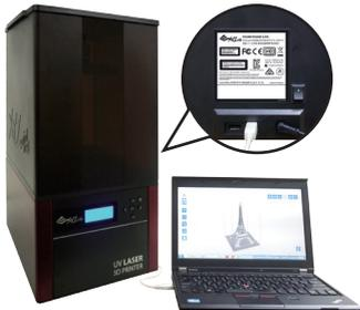
⑨ Подключите принтер к своему ПК с помощью USB-кабеля и установите программное обеспечение для печати XYZware\_Nobel с USB-накопителя из комплекта поставки.
