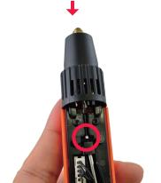
Слегка надавите на инструмент, чтобы он полностью вошел в тракт подачи нити. Конец инструмента продвинется приблизительно на 1 см через круглое отверстие.
