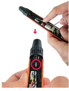
Перемещайте инструмент от себя и на себя. Остатки материала из модуля экструдера можно удалить через отверстие.
